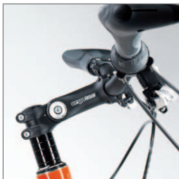
Ahead-Vorbau mit Spacern
